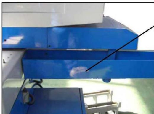
1. Соберите щелевую коробку для хранения охлаждающей жидкости (зафиксированную тремя затянутыми винтами)
