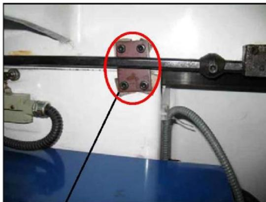
2. Отвинтите затянутый болт, который используется для фиксирования салазок
