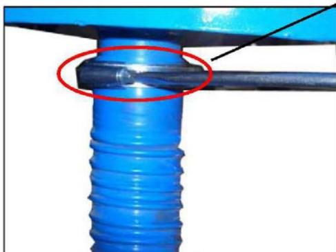
2. Соберите трубопровод для хранения охлаждающей жидкости и закрепите
