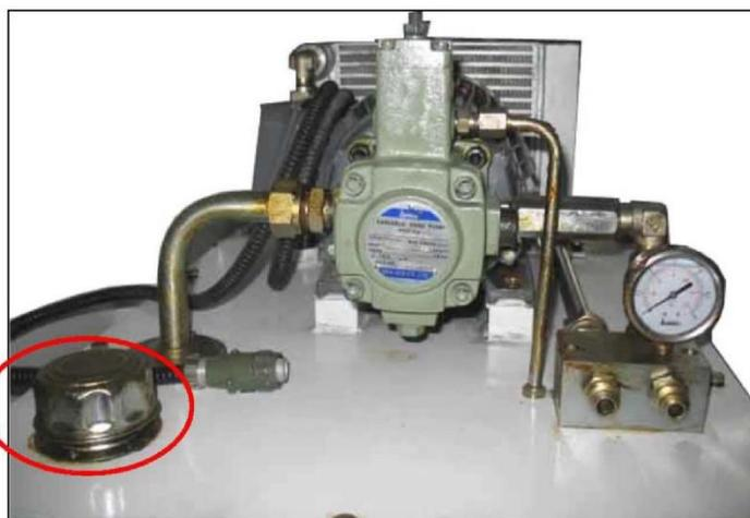
Заполните подходящим маслом (гидравлическое масло 32#) через верх цистерны.
