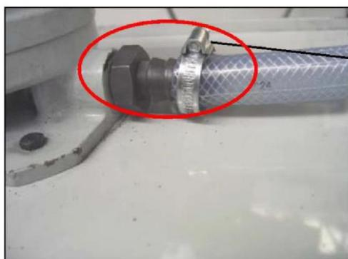
3. Присоедините трубу к насосу для подачи охлаждающей жидкости и закрепите. Вы можете поместить трубу в горячую воду на несколько минут для облегчения установки
