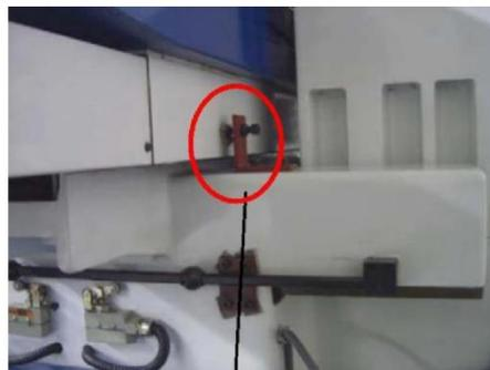
1. Отвинтите затянутый болт, который используется для фиксирования салазок
