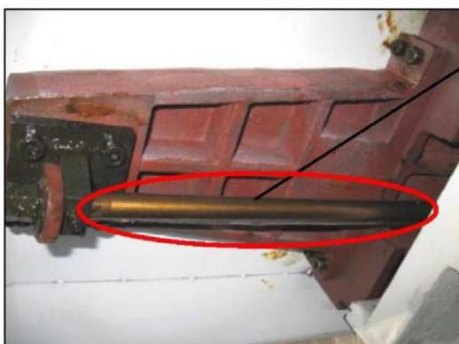
4. Удалите антикоррозионную бумагу, которая покрывает шток гидравлического поршня. Очистите направляющую скольжения салазок.
